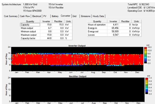
Fig. 4.6 Inverter output
