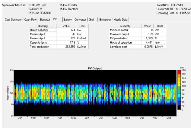
Fig. 4.5 PV output
