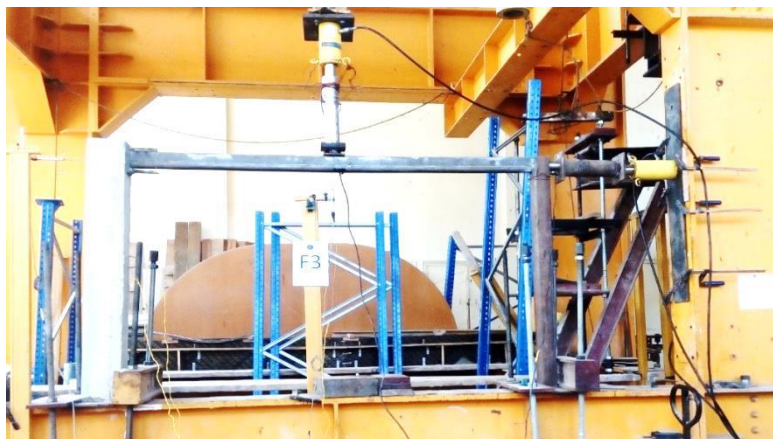
4-a) Concrete-Steel Frame
