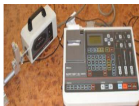
Fig. 4 Surface roughness apparatus (surftest Sv-400)
